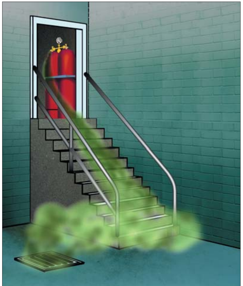
Bild 28: Ausbreitungsverhalten am Beispiel von Flüssiggas [1].
