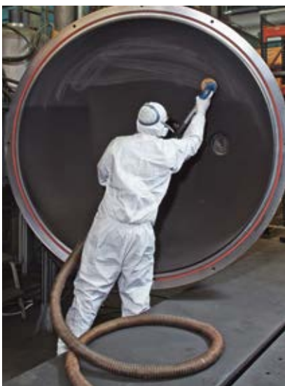
Bild 5 Spritzkabinen nur mit zugelassenen Industriestaubsaugern und persönlicher Schutzausrüstung reinigen.
