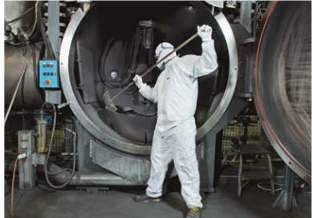
Bild 4 Beim Reinigen von Spritzkabinen besteht eine hohe Gefährdung durch Spritzstäube.
