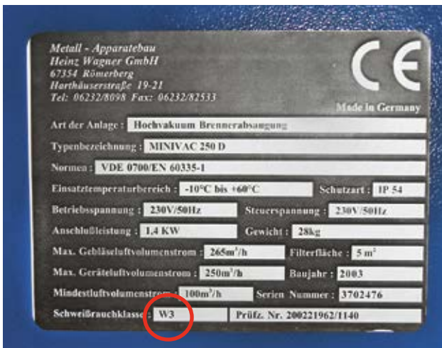
Bild 2 Typenschild einer Brennerabsaugung mit der Schweißrauchabscheideklasse W3
